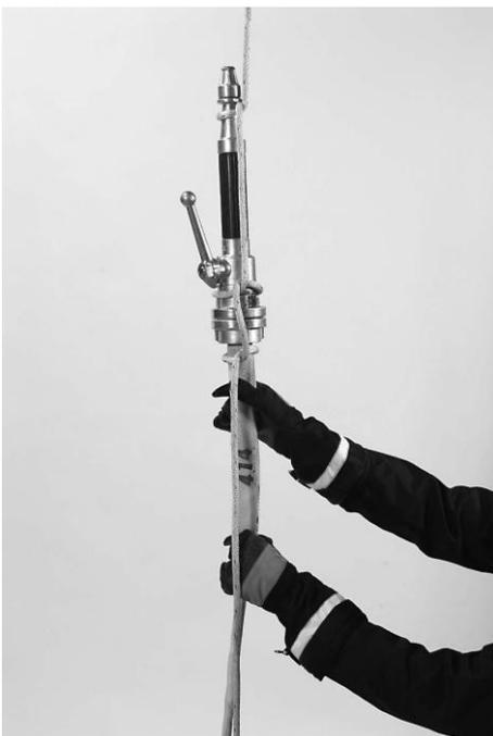
Befestigen und Hochziehen von Strahlrohr und Schlauch
